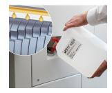
Für konstant hohe Schnittleistung und -qualität ist ein automatischer Öler integriert.
