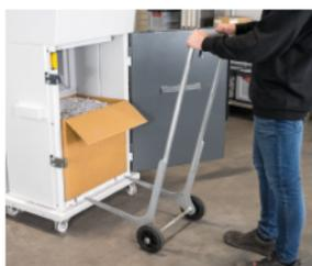
Durch den Entnahmewagen lässt sich der kompakte Ballen einfach abtransportieren und entsorgen.
