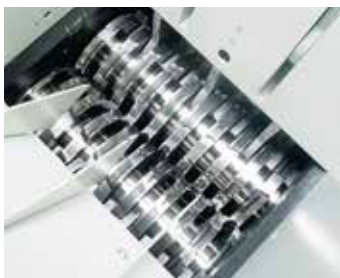
Schneidwerk 1. Stufe: Vorzerkleinerer
