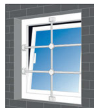
Montage auf dem Fensterrahmen
