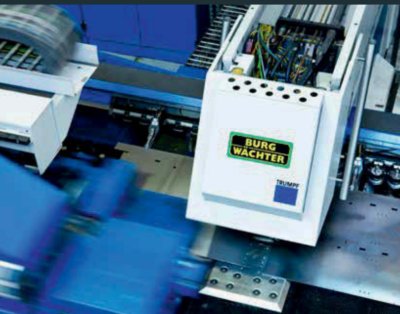
Präzise: Modernste Maschinen sind bei uns im Einsatz, um wichtige Arbeitsschritte ganz exakt durchzuführen. Hier werden Teile von hochwertigen Edelstahl-Briefkästen ausgestanzt.
